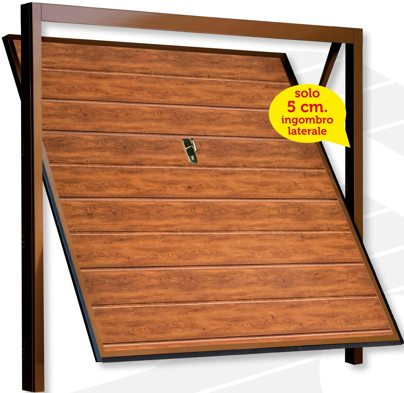
Porta fornita con spalle da 5 cm. pronta da installare, costruita in struttura metallica scatolata a "L", il telo viene eseguito con pannelli sandwich a doppia lamiera schiumati all'interno spessore 40 mm. lisci, dogati, o a cassettoni. La finitura esterna può avere striature effetto legno noce chiaro o scuro o nei colori standard 6005, 6009, 7035, 8014, 9006, 9010, 1013, 7016 POLIGRAIN.
